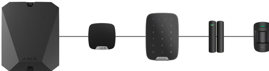
Bei der **Linientopologie** unbedingt einen 120-Ohm-Abschlusswiderstand am Ende der Linie installieren (im Lieferumfang der Hub-Zentrale enthalten). Der Abschlusswiderstand wird an die Signalklemmen des letzten Melders der Linie angeschlossen.
