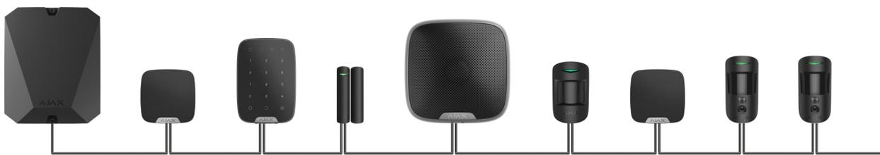
**Die Verbindung in einer Ringtopologie** belegt zwei Busausgänge der Hub-Zentrale. Sollte der Ring unterbrochen werden, wird kein einziges Gerät deaktiviert. Stattdessen werden zwei Linien gebildet, die den normalen Betrieb aufrechterhalten. Die Benutzer und das Sicherheitsunternehmen werden über die Leitungsunterbrechung benachrichtigt.
